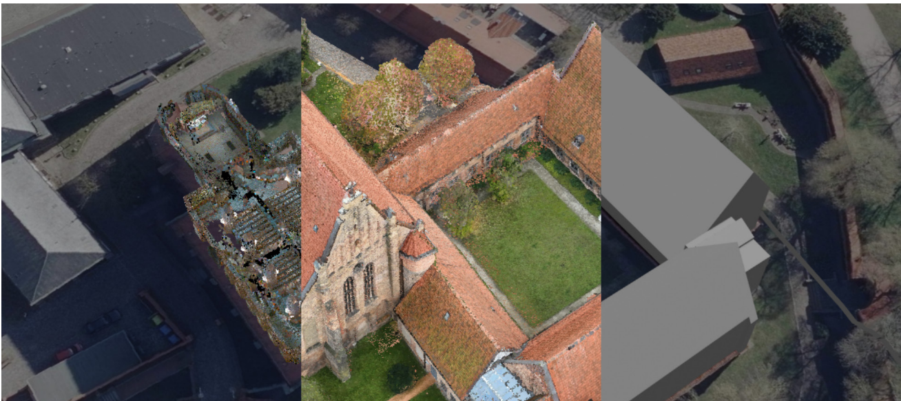
Das Kloster zum Heiligen Kreuz in Rostock, Darstellung von links nach rechts: Indoor Punktwolke, digitales Oberflächenmodell (DOM) als Punktwolke und LoD2, untexturiert.
