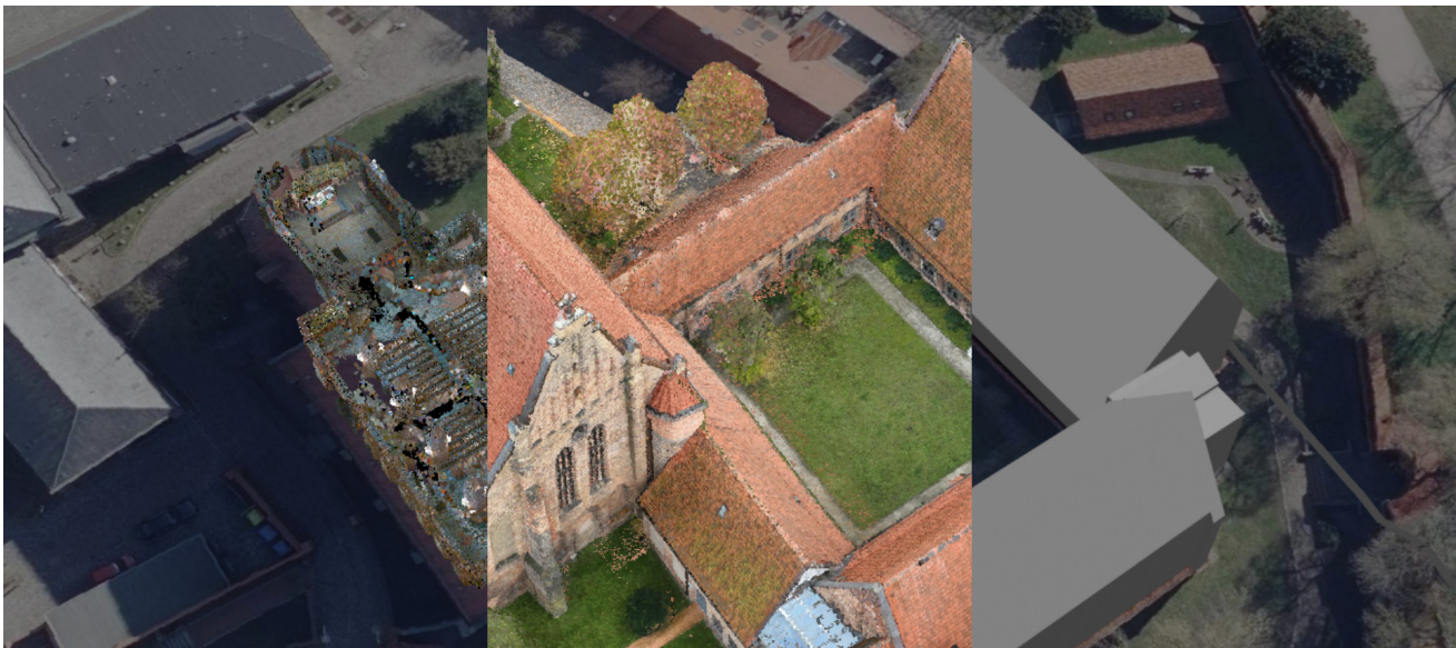
Abbildung 3: Das Kloster zum Heiligen Kreuz in Rostock, Darstellung von links nach rechts: Indoor Punktwolke, digitales Oberflächenmodell (DOM) als Punktwolke und LoD2, untexturiert.
